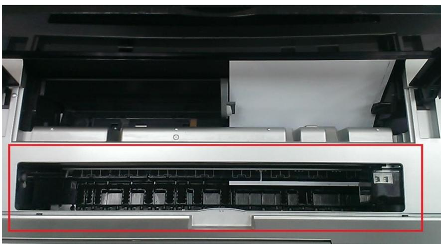
步驟 2、檢查完機器內部卡紙情況後，先將印字頭移開卡紙位置，再把紙張從上方輕取出，不要傷到印字頭（取出卡紙時盡可能保持紙張完整性）。
