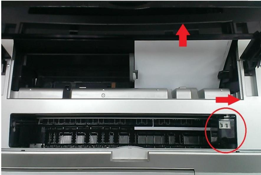
步驟 3、如取出卡紙時發現紙張有破損不完整，請將前方進紙匣打開。
